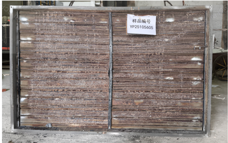
照片 2 耐火性能试验结束后试件情况
